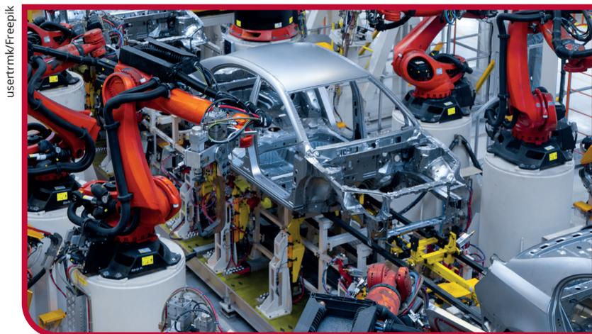
Os braços mecânicos compõem partes diferentes do carro ao mesmo tempo e de forma agilizada, tornando o processo de produção mais rápido.
